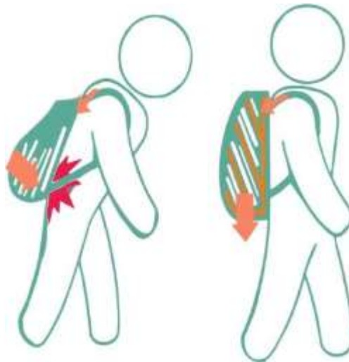
Gambar 2 32 skema alokasi beban pada tas dengan bawaan rapi dan tidak
