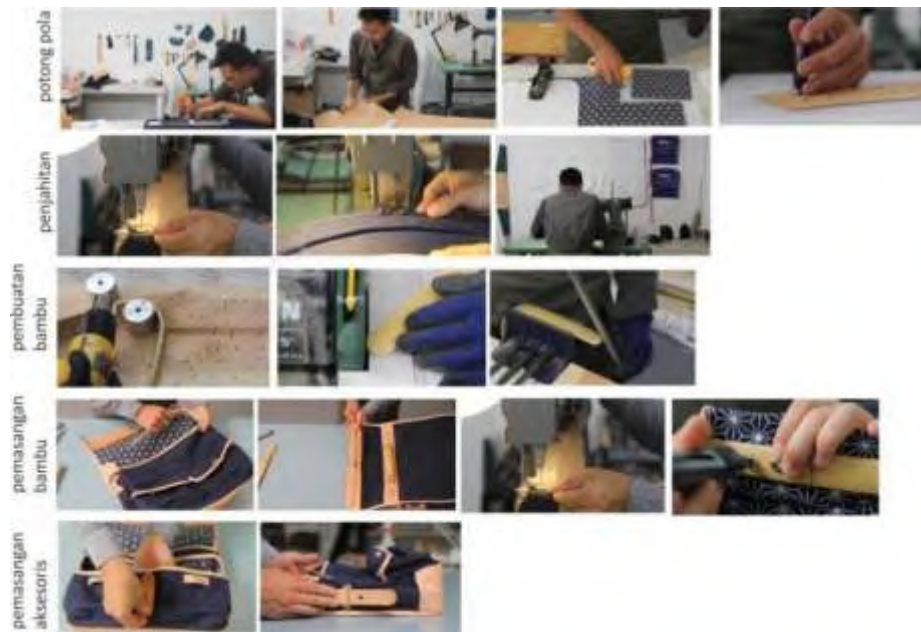
Gambar 4 30 proses pembuatan townsenf briefcase
