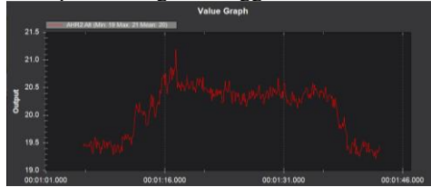
Gambar 4.8. Grafik Altitude mode Loiter
