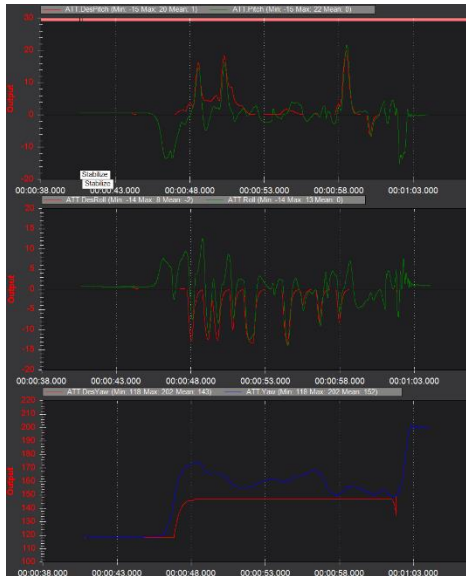
Gambar 4.7. Grafik Pitch , Yaw , Roll pada mode Stabilize
