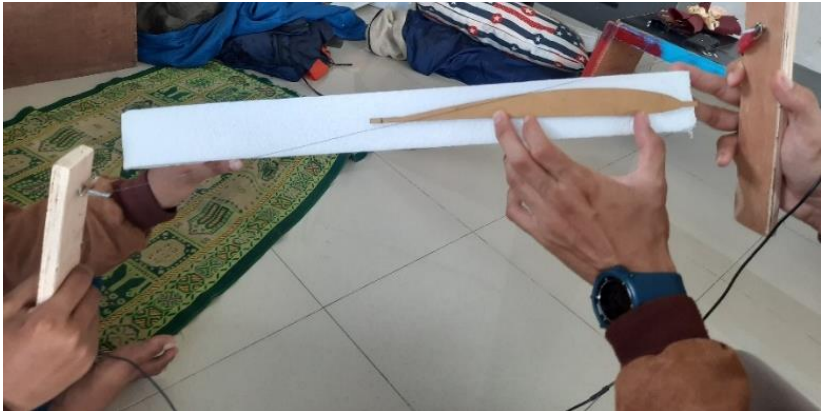
Gambar 3.32. Tahap Pembuatan Sayap UAV
