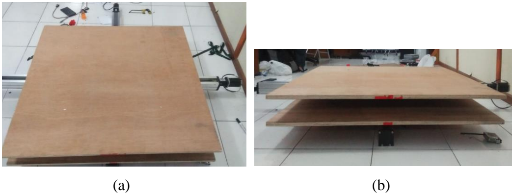
Gambar 4.1 EST dua sumbu dengan penggerak ball screw linear guide actuator (a) tampak atas (b) tampak samping
