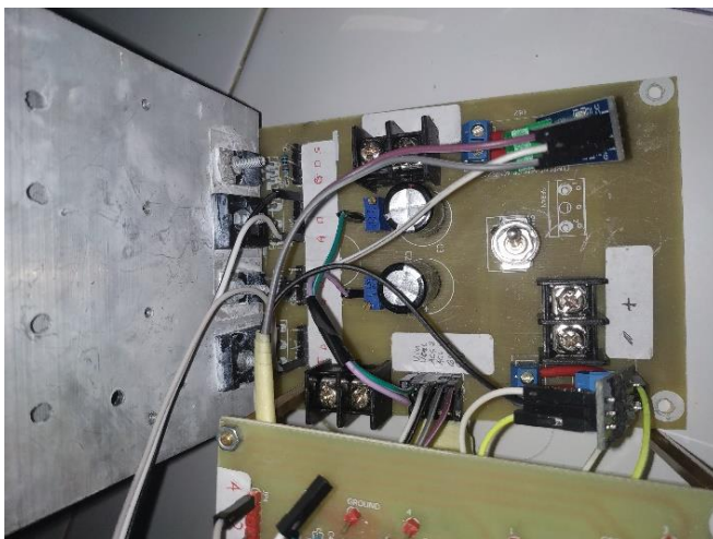
Gambar 3.20 Implementasi Konverter (a) Rangkaian Driver dan Baterai (b) Rangkaian Konverter
