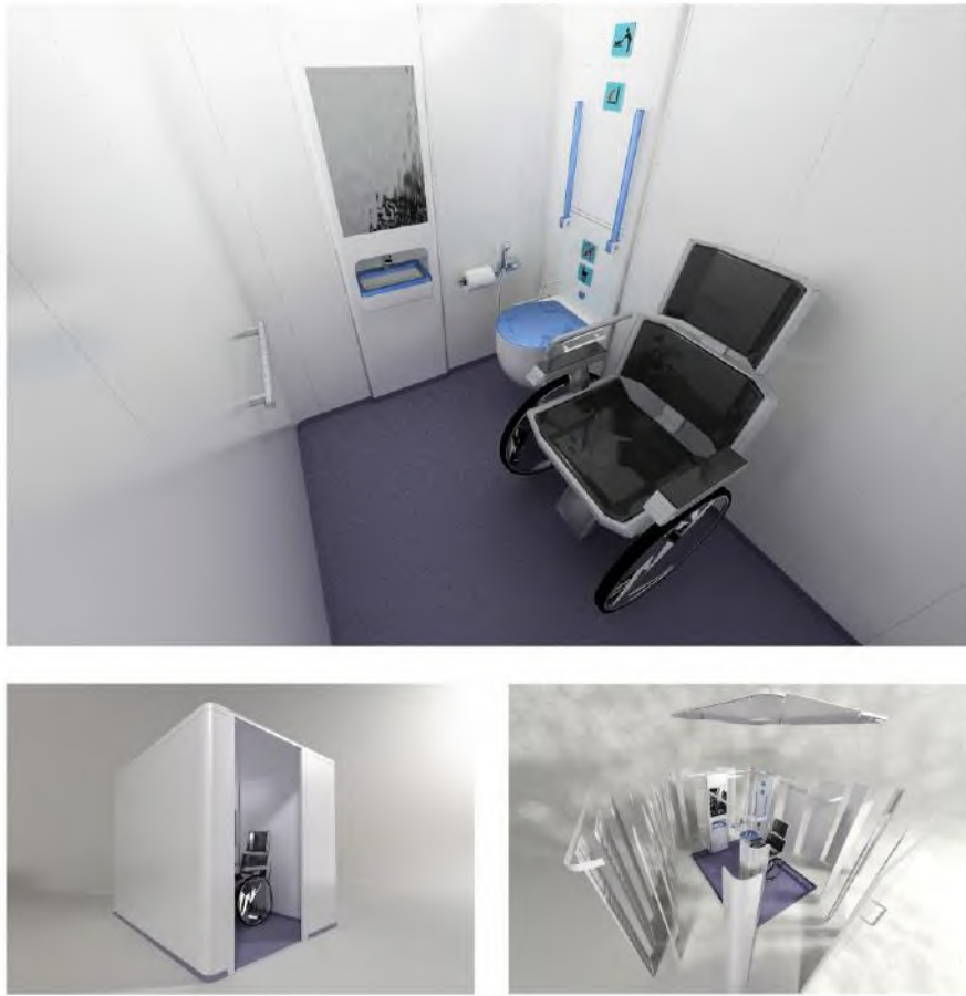
Gambar 6. 8 Desain akhir lavatory untuk penumpang berkebutuhan khusus
