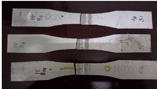
Gambar 4.1 Hasil Spesimen 15cfh Setelah di Uji Tarik Patah Di HAZ
