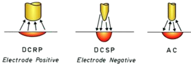
Gambar 2.2 Tiga Jenis arus listrik pada Las GTAW
