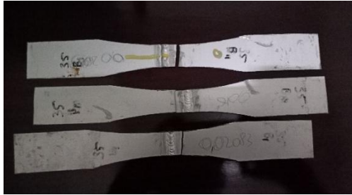
Gambar 4.3 Hasil Spesimen 35cfh Setelah di Uji Tarik Patah Di HAZ
