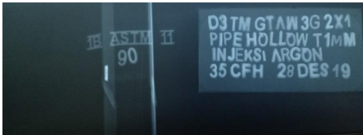
Hasil Radiografi Spesimen 35cfh Posisi 90°
