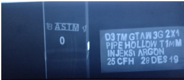
Hasil Radiografi Spesimen 25cfh Posisi 0°
