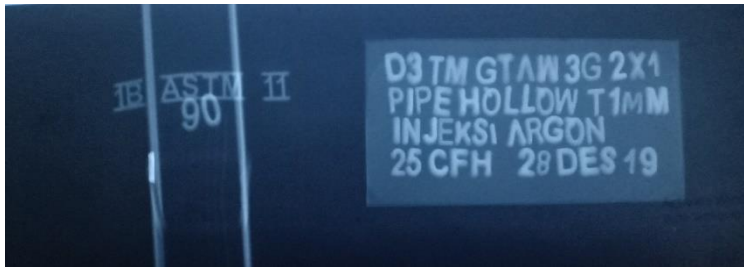
Hasil Radiografi Spesimen 25cfh Posisi 90°
