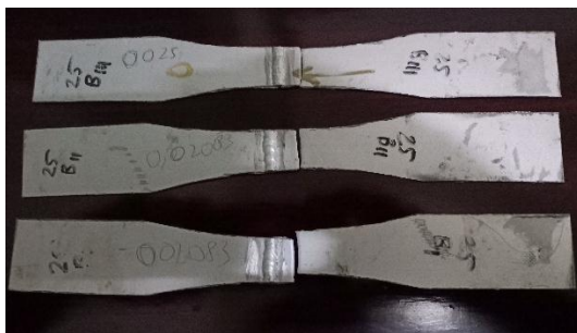
Gambar 4.1 Hasil Spesimen 15cfh Setelah di Uji Tarik Patah Di HAZ
