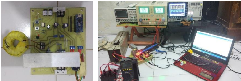
Gambar 3.49 Implementasi rangkaian Konverter Boost (Kiri) dan Pengujian Efisiensi Konverter Boost (kanan)
