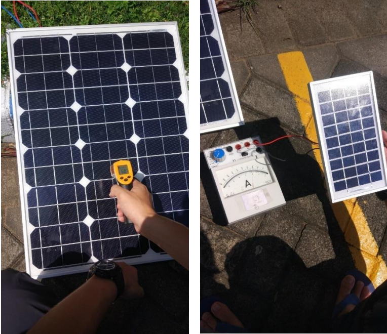
Gambar 3.50 Tes Suhu Cell menggunakan Infrared (Kiri) dan Tes Iradiasi menggunakan PV 3WP dengan Amperemeter (Kanan)
