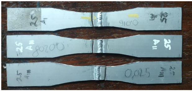
Gambar 4.2 Spesimen 25cfh Setelah Diuji Tarik Patah Di HAZ
