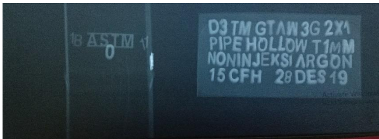
Hasil Uji Radiografi 15cfh posisi 0°
