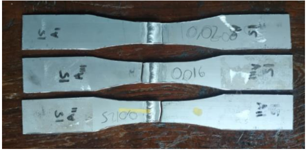
Gambar 4.1 Spesimen 15cfh Setelah Diuji Tarik Patah Di HAZ
