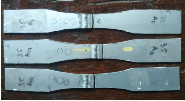
Gambar 4.3 Spesimen 35cfh Setelah Diuji Tarik Patah Di HAZ
