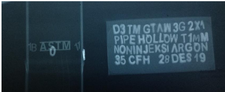
Hasil Uji Radiografi 35cfh posisi 0°
