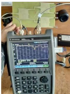
**Gambar 4.10** Pengukuran *Power Divider* Menggunakan *Vector Network Analyzer*
