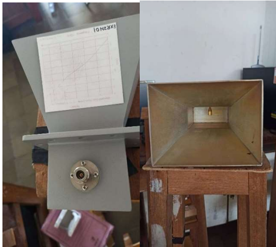
Gambar3.6 Antena Horn sebagai antena referensi
