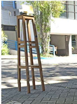
Gambar3.7 Penyangga non metal untuk menyangga antena referensi
