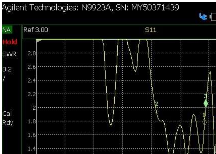
Gambar4.38 VSWR Hasil pengukuran Antena Fabrikasi port 1
