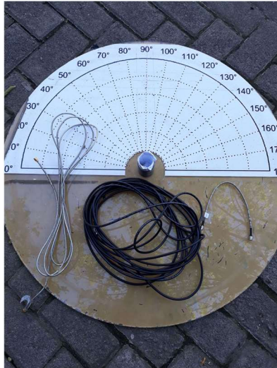
Gambar3.5 Busur acuan pengukuran pola radiasi dan kabel yang digunakan.
