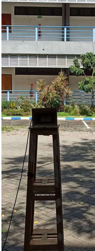
Gambar6.7 Penyangga Antena Referensi dengan Tinggi 1,24 m
