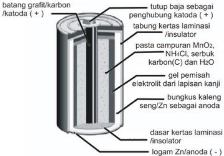
Gambar 2.1 Komponen Baterai
