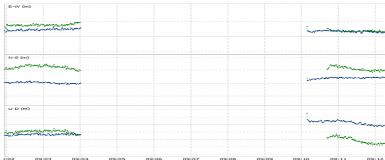
Gambar 4.43 Kecepatan kembali ke fix percobaan ke-satu
