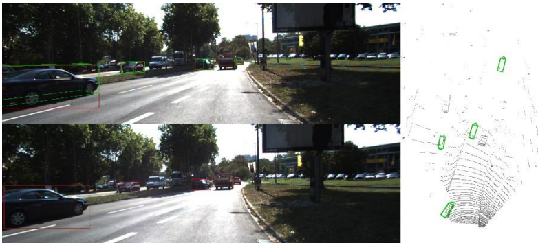
Gambar 4.6. Demonstrasi Stereo R-CNN dengan gambar mobil yang terpotong sebagian.
