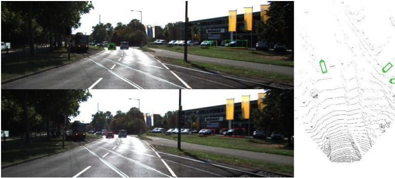
Gambar 4.7. Demonstrasi Stereo R-CNN dengan beberapa kendaraan tidak terdeteksi.
