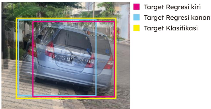
Gambar 3.7. Perbedaan penugasan target untuk regresi dan klasifikasi
