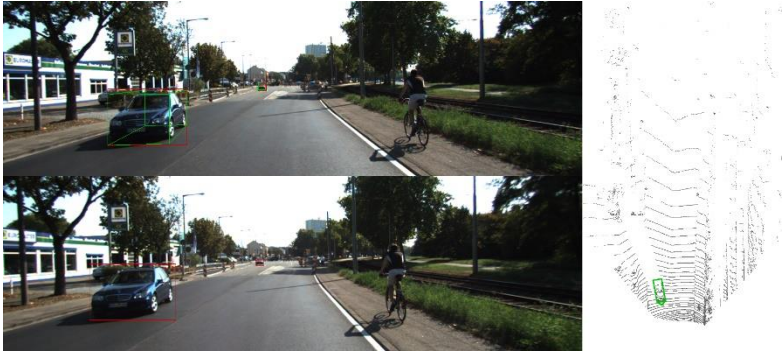
Gambar 4.5. Demonstrasi Stereo R-CNN. ( atas: bounding box 3D; bawah : klasifikasi & bounding box 2D; kanan: bird eye's view)
