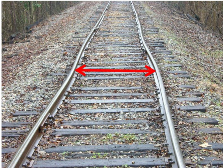
Gambar 2. 4 Parameter Lebar Sepur pada lintasan kereta api
