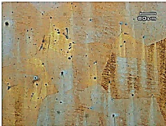
Gambar 4.12 Perlakuan panas pada temperatur 1100 °C ditahan 2 jam pendinginan air diagitasi (Hidayat et al, 2018).
