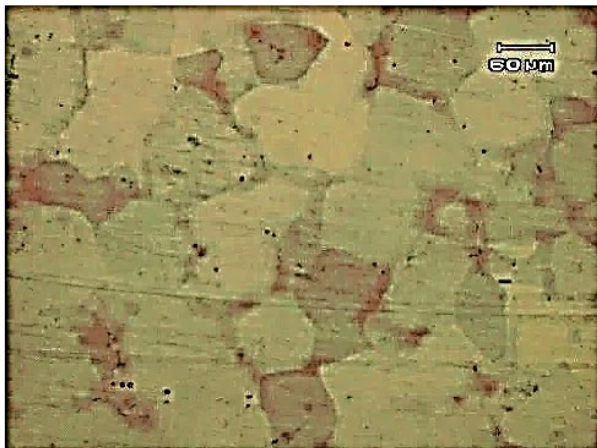
Gambar 4.13 Perlakuan panas bertahap pada 700°C ditahan 3 jam dinaikan ke temperatur 1000°C ditahan 1,5 jam pendinginan air diagitasi (Hidayat et al, 2018).
