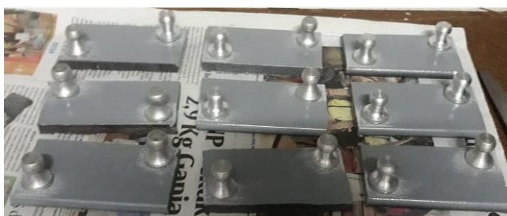
Gambar 3.14 Spesimen yang telah dipasang dolly
