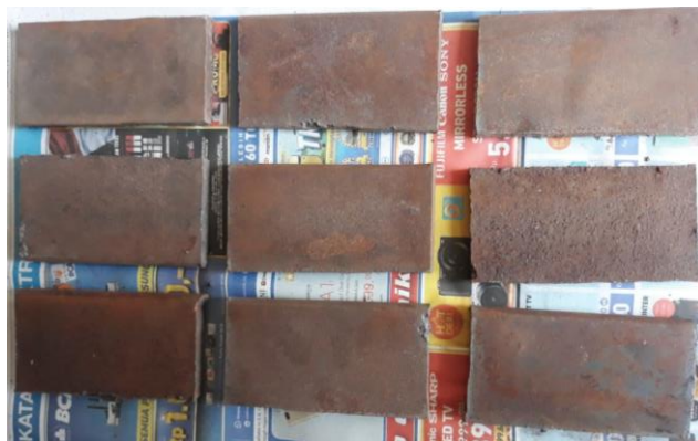
Gambar 4.1 Spesimen Sebelum di Blasting
