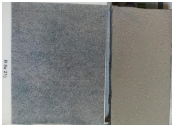
Gambar 4.3 Hasil Visual Blasting dengan Material Abrasif Pasir Silika
