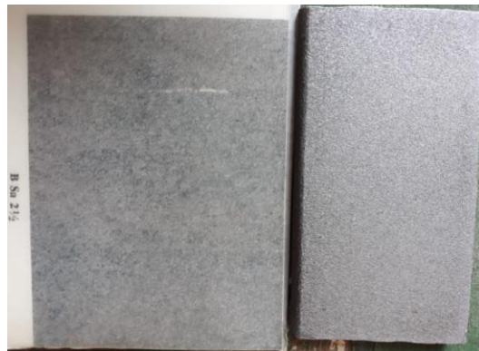
Gambar 4.4 Hasil Visual Blasting dengan Material Abrasif Steel Grit
