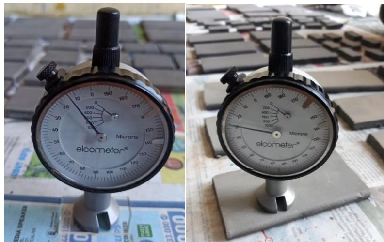
Gambar 3.8 (a) Kalibrasi Roughness Meter , (b) Pengujian Spesimen
