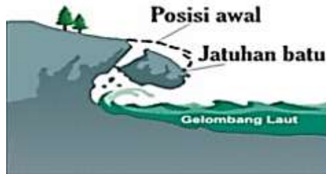
Gambar 2.4 Longoran Runtuhan Batu (sumber: ESDM 2006)
