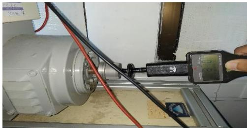
**Gambar 3. 36** Pengukuran Kecepatan Putar Generator DC
