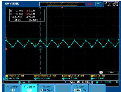
**Gambar 4. 7** Gelombang Arus Induktor Multi-Input DC/DC Konverter
