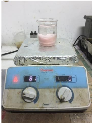
Gambar 6 Menguapkan NaCl untuk membentuk pori
