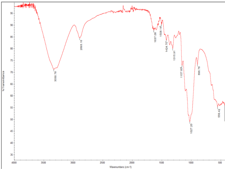
Gambar 8 Hasil uji FTIR Nanoselulosa
