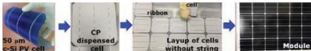
Gambar 2. 2 Proses pembuatan modul PV (Song, 2018)
