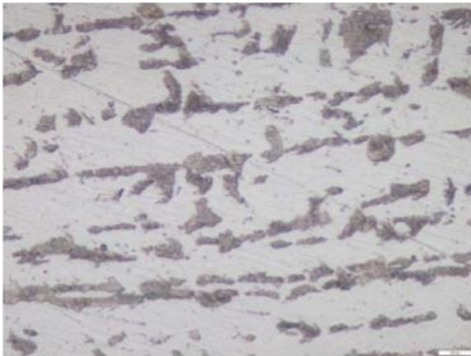
Gambar 4. 22 Foto mikro HAZ pengelasan SMAW di darat (Kalila, 2017)
