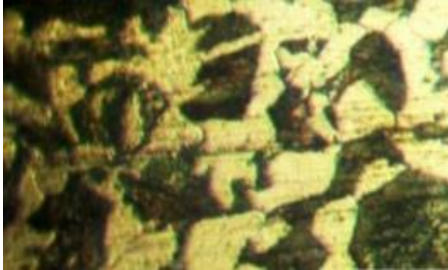
Gambar 4. 14 Foto mikro base metal pengelasan SMAW di darat (Tommy, 2016)
