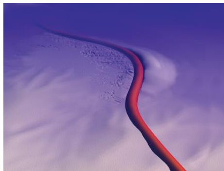
Gambar 3. Ilustrasi global buckling pada pipa bawah laut (Sumber: anakkelautan.wordpress.com )
