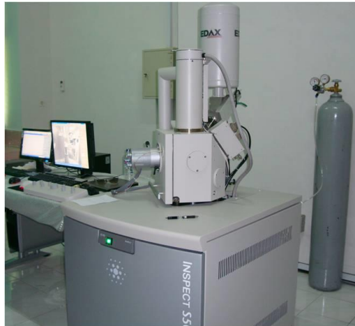
Gambar 3.2 Seperangkat peralatan SEM di Laboratorium Sentral Universitas Negeri Malang
