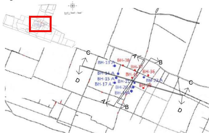
Gambar 4. 5 Rencana Zonasi Statigrafi Titik Uji Bore Log Pada Area Gedung Terminal
