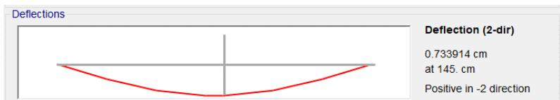
Gambar 4.24 Hasil Lendutan Balok Penumpu Tangga Berdasarkan ETABS
