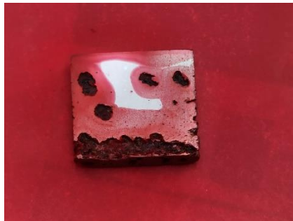
Gambar 4.9 Hasil uji NDT sampel 35°C setelah uji imersi
