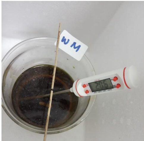
Gambar 3.6 Pengukuran temperature pada spesimen uji 20°C
