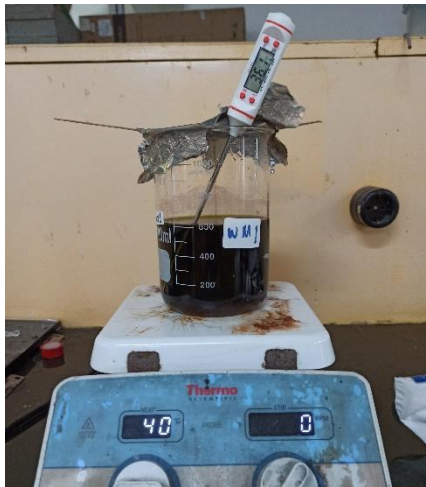
Gambar 3.8 Pengukuran temperature pada spesimen 35°C
