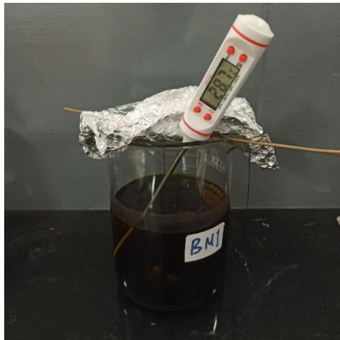
Gambar 3.7 Pengukuran temperatur pada spesimen 30°C
