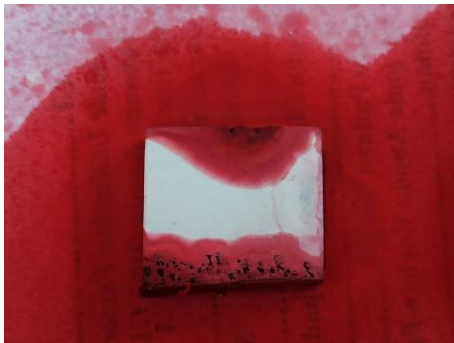
Gambar 4.6 Hasil uji NDT sampel 15°C setelah uji imersi
