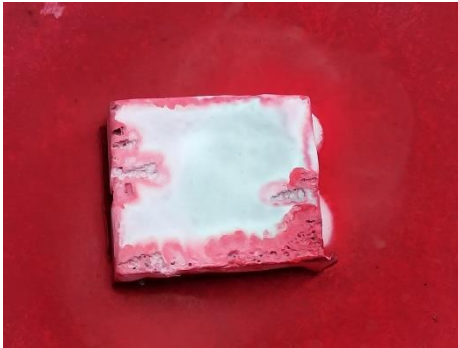
Gambar 4.7 Hasil uji NDT sampel 20°C setelah uji imersi
