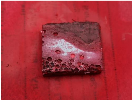
Gambar 4.8 Hasil uji NDT sampel 30°C setelah uji imersi
