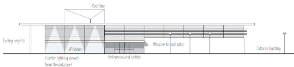
Gambar 37 Elemen fasad bangunan yang dapat berkontribusi pada efisiensi energi (Ching & Shapiro, 2014)
