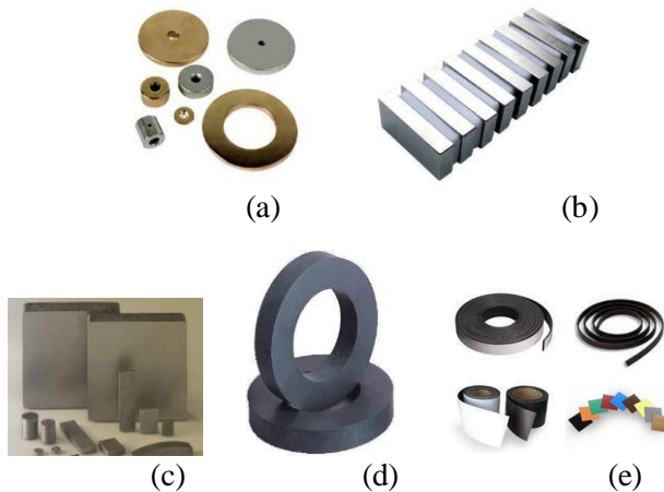
Gambar 2.2 Jenis-Jenis Material Magnet Permanen (a) Magnet Alnico, (b) Neodymium magnet, (c) Samarium-Cobalt magnet, (d) Keramik magnet, (e) Plastik magnet
