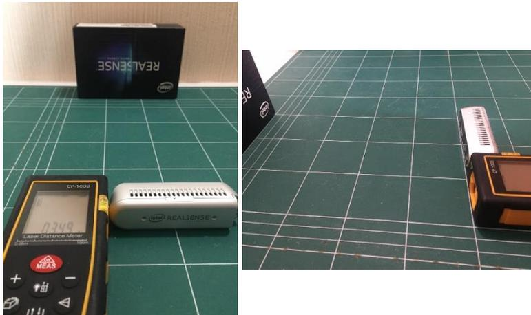
**Gambar 4.8** Posisi pengujian nilai kedalaman
