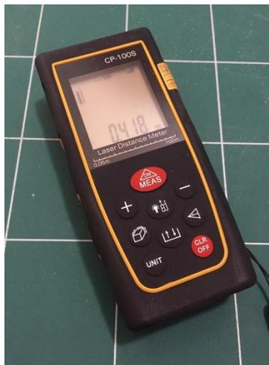
**Gambar 4.9** *Rangefinder* untuk mengukur jarak
