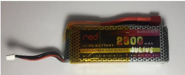
**Gambar 3.11** Baterai LiPo yang digunakan
