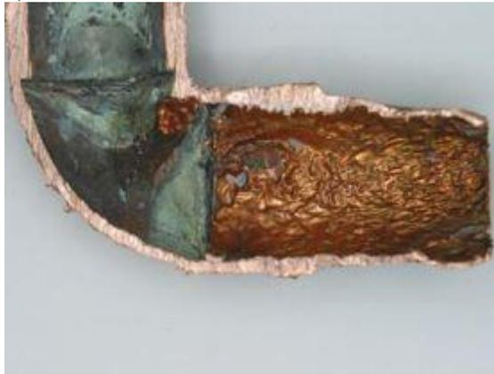
**Gambar 2. 4** Korosi erosi pada pipa (Utomo, 2009)
