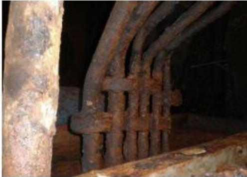
**Gambar 2. 2** Korosi seragam pada pipa ballast (Utomo, 2009)
