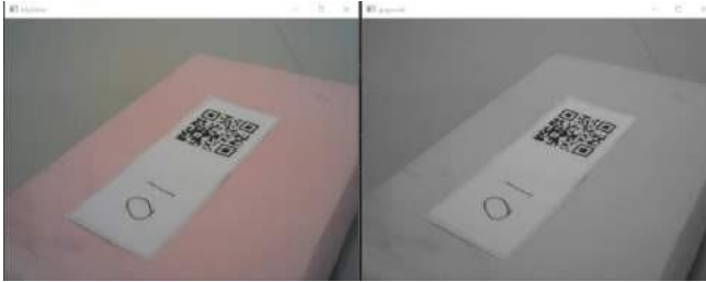
Gambar 3. 18 Hasil konversi warna ke bentuk grayscale
