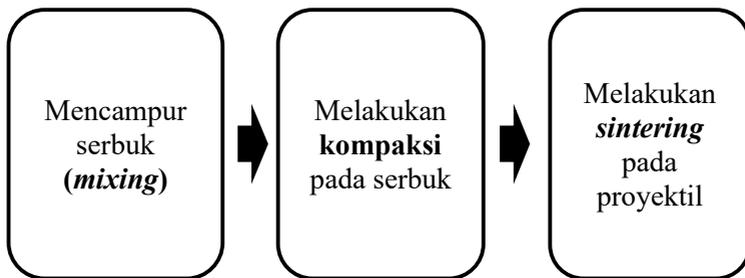
**Gambar 2.2** Proses metalurgi serbuk untuk proyektil *frangible* (ASM Metal Handbook, 1998)
