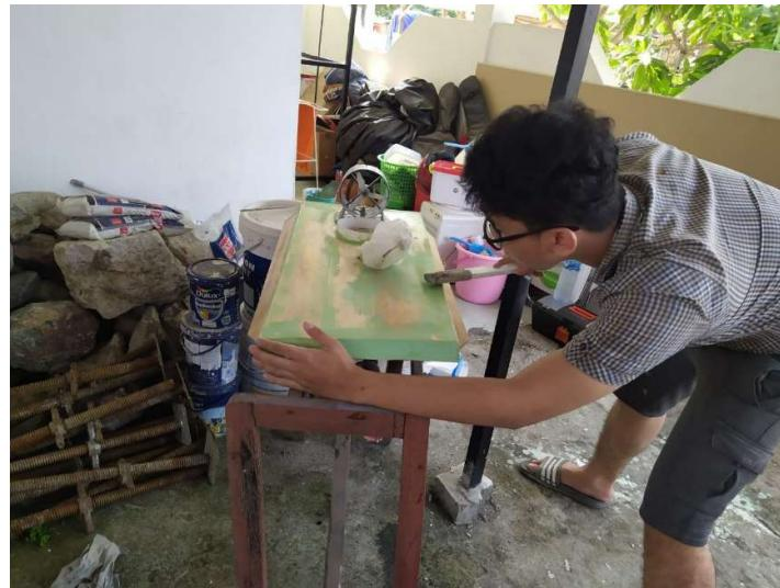
Gambar 4. 68 Penghalusan permukaan prototype dengan amplas
