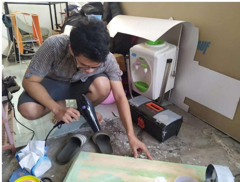
Gambar 4. 69 Pengeringan dempul basah dengan *hairdryer*
