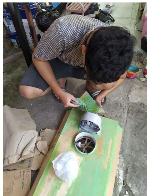
Gambar 4. 67 Pemberian dempul pada prototype
