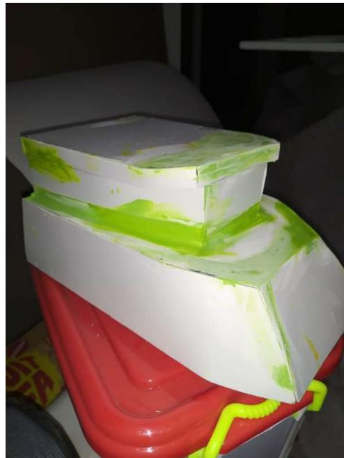
Gambar 4. 72 Bentuk bangunan atas dengan PVC Foam
