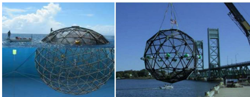
Gambar 2. 6 Rigid Frame Berbentuk Bola yang Digunakan pada Laut Dalam
