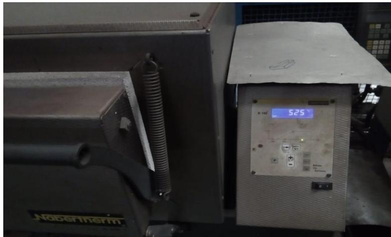
**Gambar 3.18** Proses Solution treatment dengan suhu 525°C
