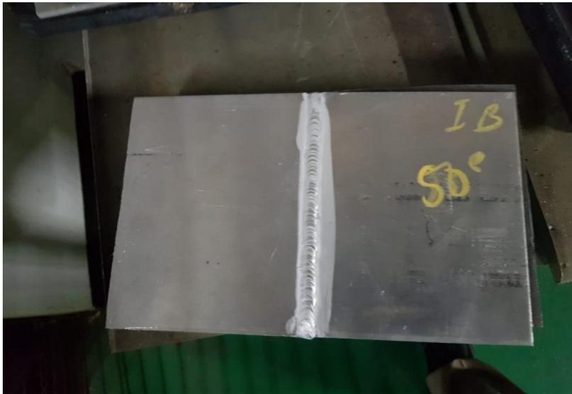
**Gambar 4.4** Hasil pengelasan spesimen 1B
