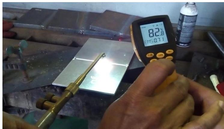
**Gambar 3.13** Pengukuran suhu dengan termogun
