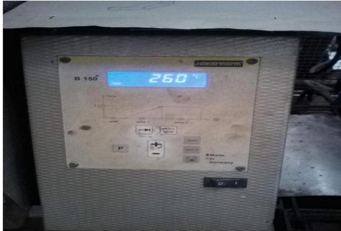
**Gambar 3.21** Aging treatment pada suhu 260°C
