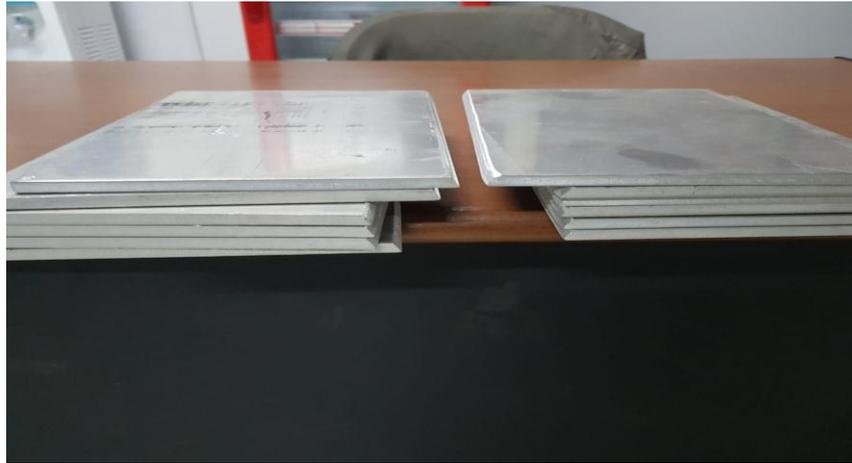
**Gambar 3. 4** Material aluminium 6061 dengan sudut bevel 60°
