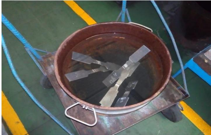
**Gambar 3.19** Proses quenching menggunakan air
