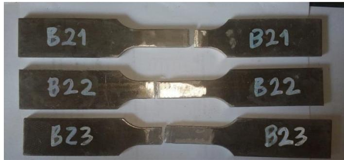
**Gambar 4.21** Hasil pengujian tarik pada Spesimen B2
