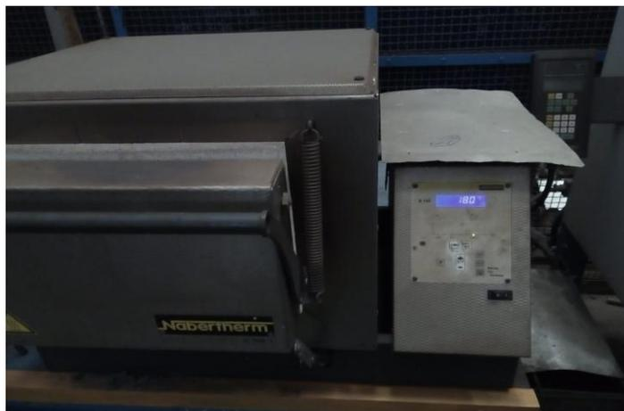
**Gambar 3.20** *Aging treatment* pada suhu 180°C
