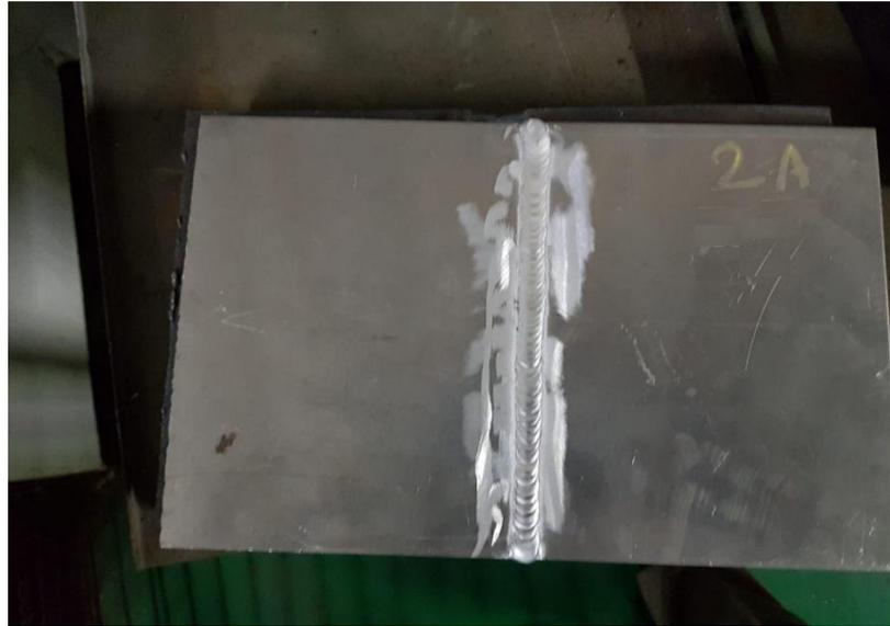
**Gambar 4.5** Hasil pengelasan spesimen 2A
