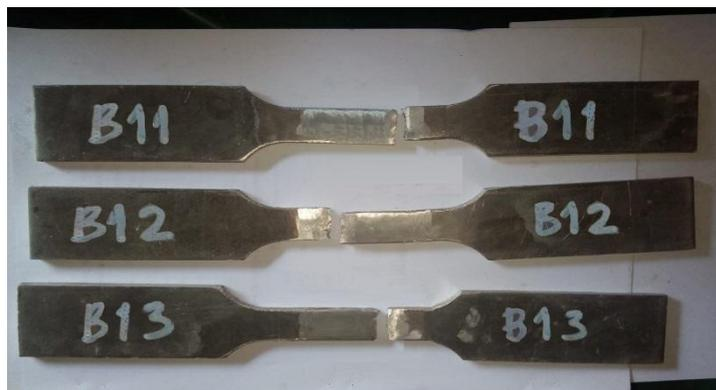
**Gambar 4.20** Hasil pengujian tarik pada Spesimen B1
