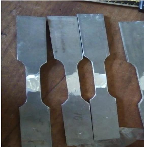
**Gambar 3.23** Spesimen uji tarik
