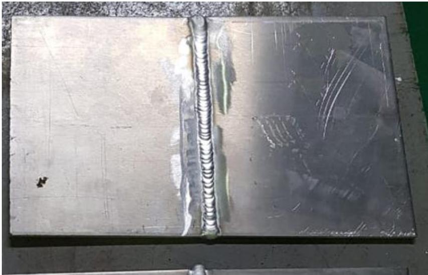
**Gambar 4.2** Hasil pengelasan *joint* tanpa perlakuan panas
