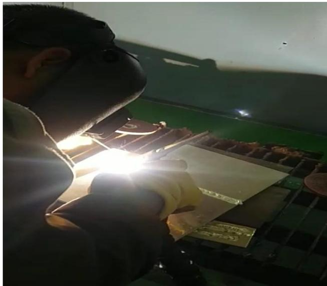
**Gambar 3.17** Proses pengelasan dengan GTAW
