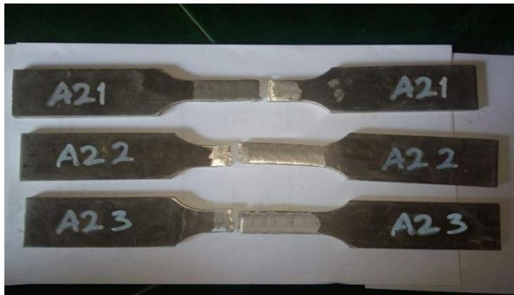
**Gambar 4.18** Hasil pengujian tarik pada Spesimen A2
