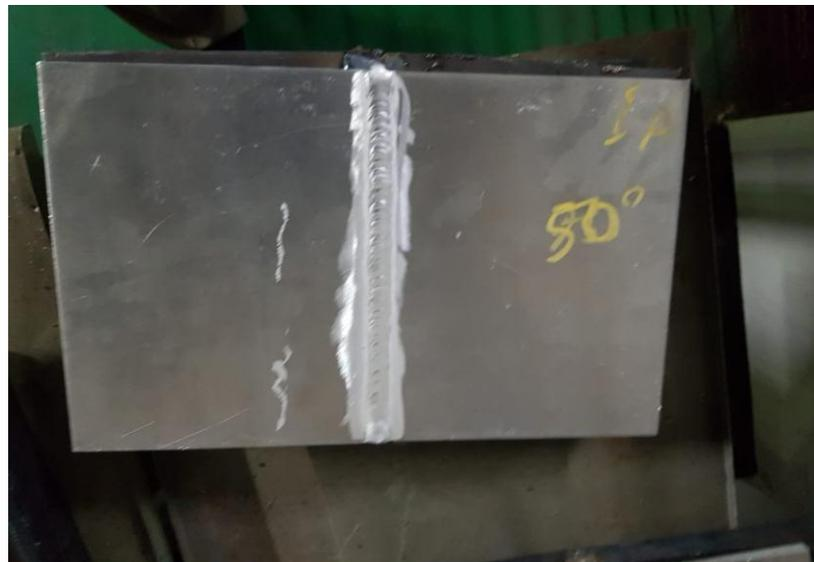
**Gambar 4.3** Hasil pengelasan spesimen 1A
