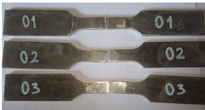
**Gambar 4.16** Hasil pengujian tarik pada Spesimen A1
