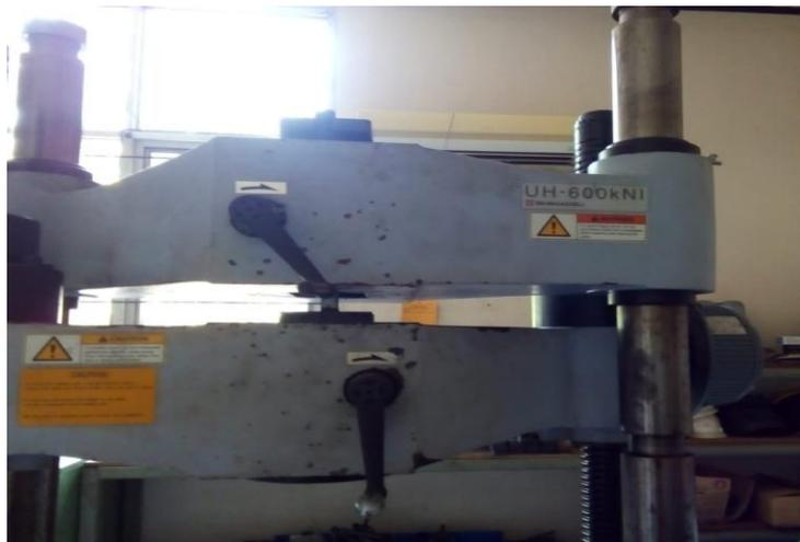
**Gambar 3.2** Mesin uji tarik
