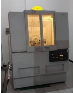
Gambar 3.13 Instrumen XRD (Dokumentasi Pribadi)
