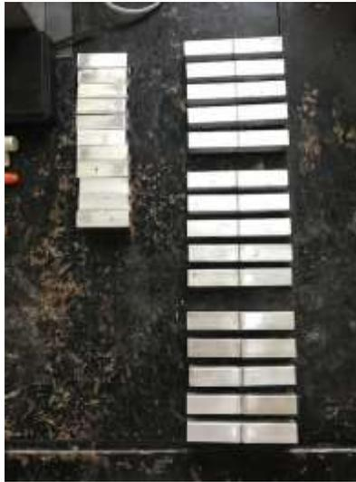
Gambar 3.21 Hasil Spesimen Sambungan *Adhesive Butt Joint*
