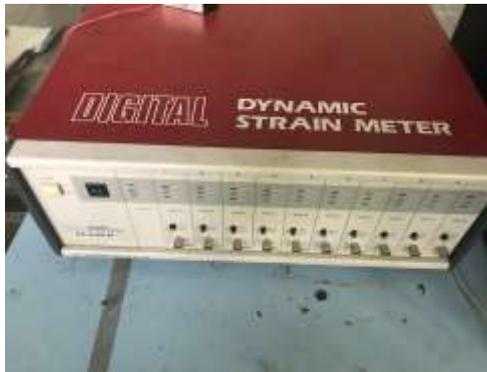
Gambar 3.8 *Dynamic Strain Meter* sebagai *A/D Converter*
