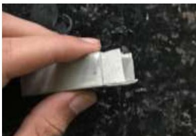
Gambar 3.14 Proses Penyambungan *Adherend* Dengan Lakban Kertas
