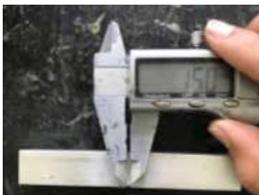
Gambar 3.15 Proses Pengukuran Ketebalan Adhesive Pada Spesimen
