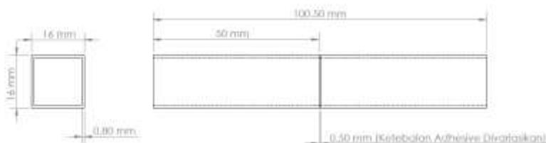
Gambar 3.5 Dimensi Spesimen Sambungan *Adhesive Tipe Butt Joint*
