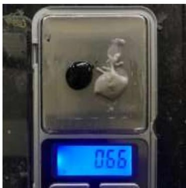
Gambar 3.16 Proses Penimbangan Komposisi Rasio Epoxy-Hardener
