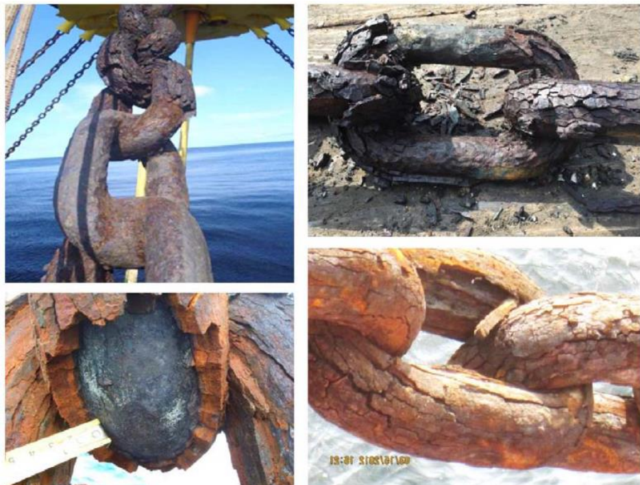
Gambar 1.2 Degradasi Diameter Rantai Akibat Faktor Korosi dan Faktor Penggunaan (Sumber : API RP 2SK 4 th Edition, 2018)
