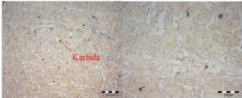
Gambar 4. 23 Hasil struktur mikro alloy 2 dengan 1,4% V (Mahlami, 2017)
