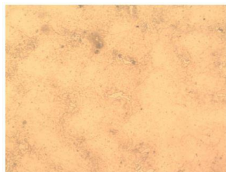
Gambar 4.4 Struktur mikro produk cor 1 Mn 10% Cr 1,7%, etsa nital, perbesaran 200x (Pratomo, 2016)
