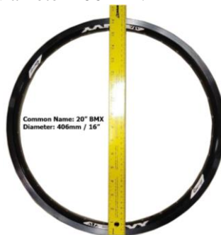
Gambar 2. 5 Pengukuran Ban Sepeda Ukuran 406 mm. (Bike, 2020)
