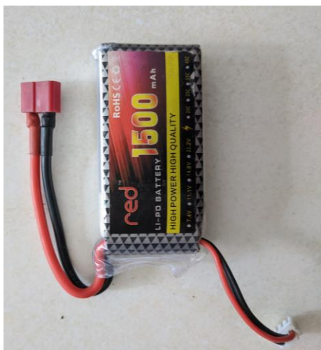
Gambar 3.29 Baterai red 2S 1500 mAh untuk Daya Sensor
