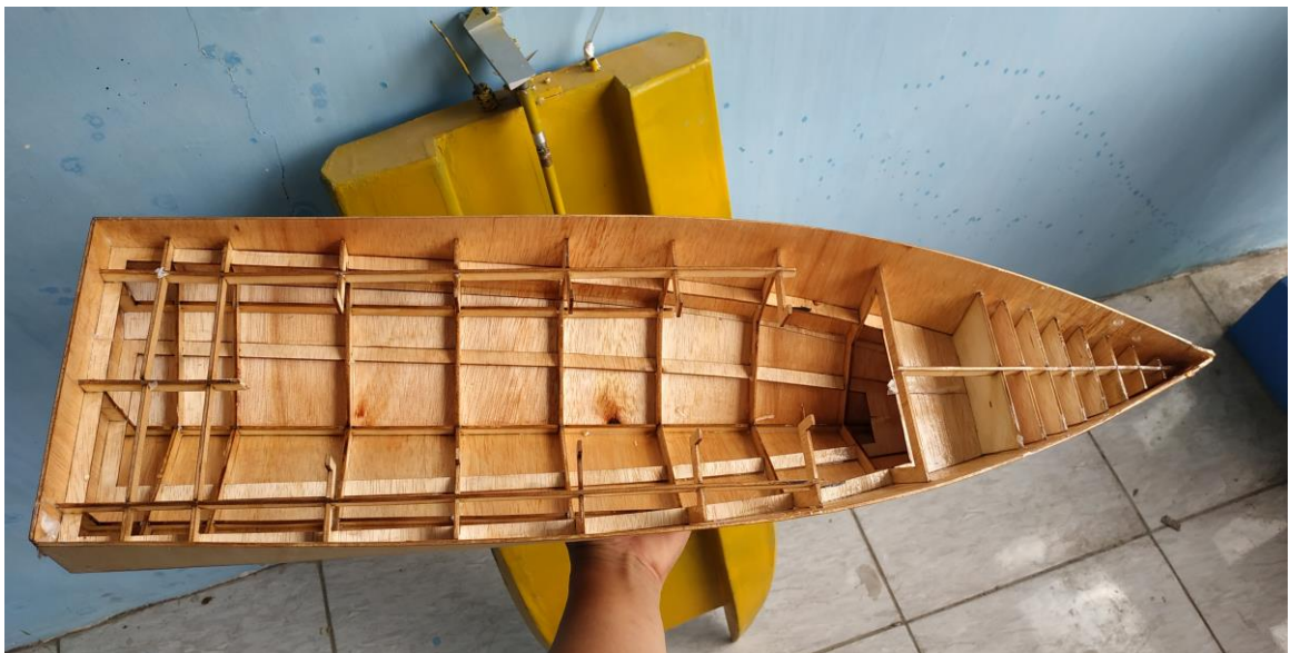
Gambar Hasil Perakitan Kulit Lambung
