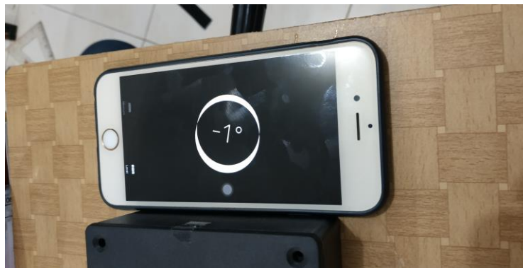
Gambar 3.39 Mencari Nilai Sudut Nol pada Clipboard dengan Membandingkannya Menggunakan Handphone
