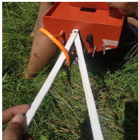
Gambar Pengukuran Sudut Rudder Menggunakan Alat Bantu
