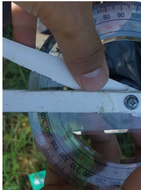
Gambar Pengukuran Sudut Alat Bantu Menggunakan Busur
