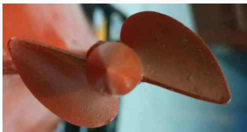
Gambar 3.9 Propeller yang Digunakan Berdaun 2
