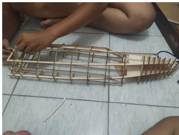
Gambar 3.15 Merangkai Konstruksi Kapal Model dengan Direkatkan Menggunakan Lem
