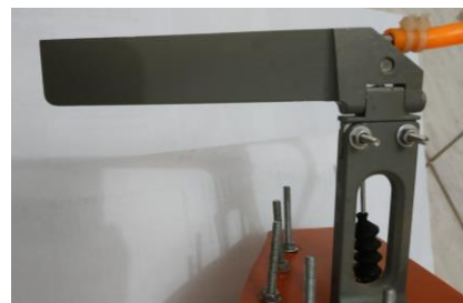
Gambar 3.10 Rudder yang Digunakan dan Telah Terpasang pada Model Kapal
