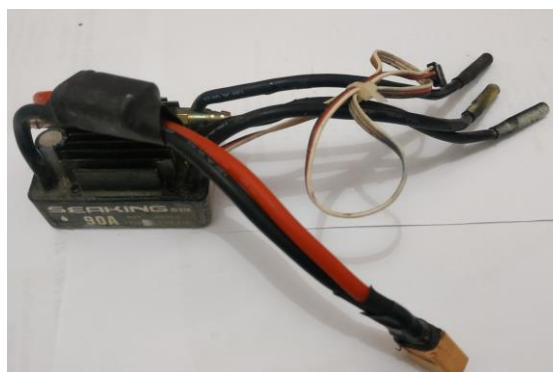
Gambar 3.3 ESC Seaking V3 RTR 90A.
