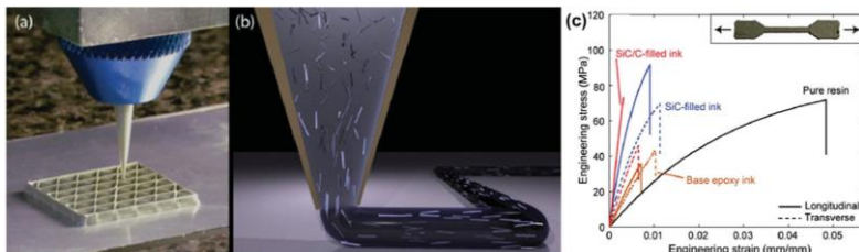
Gambar 2.6 (a) Gambar 3d Printing dari Komposit Honeycomb , (b) Ilustrasi dari Penyelarasan Progresif dari Filler dengan Rasio Tinggi dalam Nozzle saat Proses Deposisi, (c) Kurva Tegangan vs. Regangan Tarik untuk Spesimen Uji Tarik (Wang, 2017).
