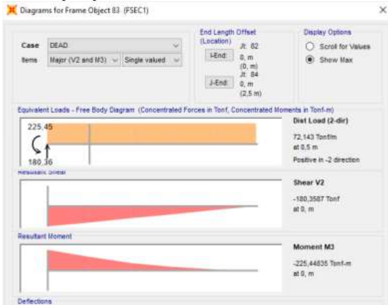
Gambar 4.47 Momen maksimum yang terjadi pada pondasi tiang pancang di bagian tepi graving dock
