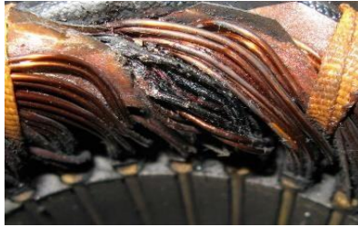
Gambar 2.3 Kerusakan pada belitan
