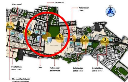
Pada konsep pejalan kaki, dengan merancang zebra cross pada perempatan jalan, dan akses dari antar bangunan, yang dilengkapi dengan penanda dan rambu agar terbaca oleh pengemudi dan penyeberang jalan, serta opsi alternatif dengan merancang Jembatan Penyeberangan Orang yang tentunya lebih aman untuk digunakan dan terintegrasi antar bangunan.
