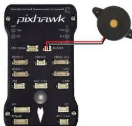
**Gambar 2. 9 Buzzer yang dihubungkan dengan pixhawk<sup>8</sup>**
