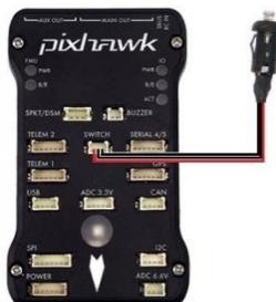
**Gambar 2. 10** Safety switch yang dihubungkan dengan pixhawk <sup>9</sup>
