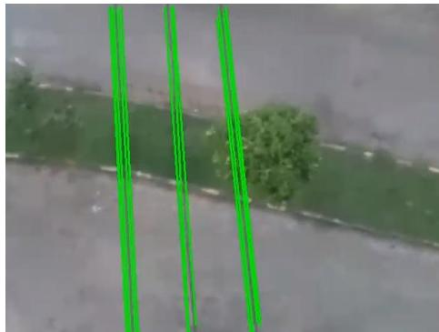
**Gambar 4. 12** Hasil deteksi kabel SUTM di Jl. Teknik Kimia ITS
