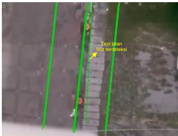
**Gambar 4. 15** Kesalahan deteksi kedua ketika pengujian dilakukan
