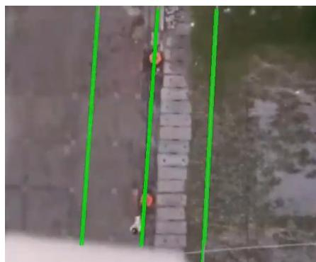
**Gambar 3. 12** Hasil deteksi garis menggunakan transformasi *Houghline*
