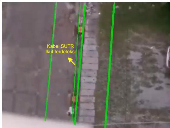
**Gambar 4. 14** Kesalahan deteksi pertama ketika pengujian dilakukan
