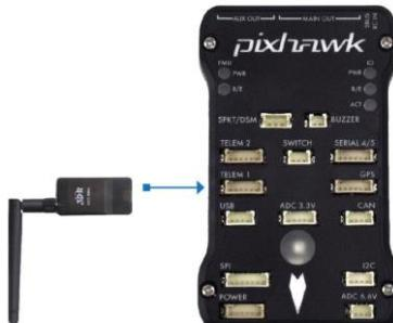
Gambar 2. 13 Cara menghubungkan *telemetry* dan pixhawk<sup>10</sup>
