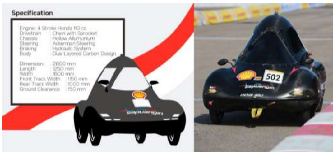
Gambar 4 19 Spesifikasi Sapuangin 11 Evo Sumber: ITS Team Sapuangin
