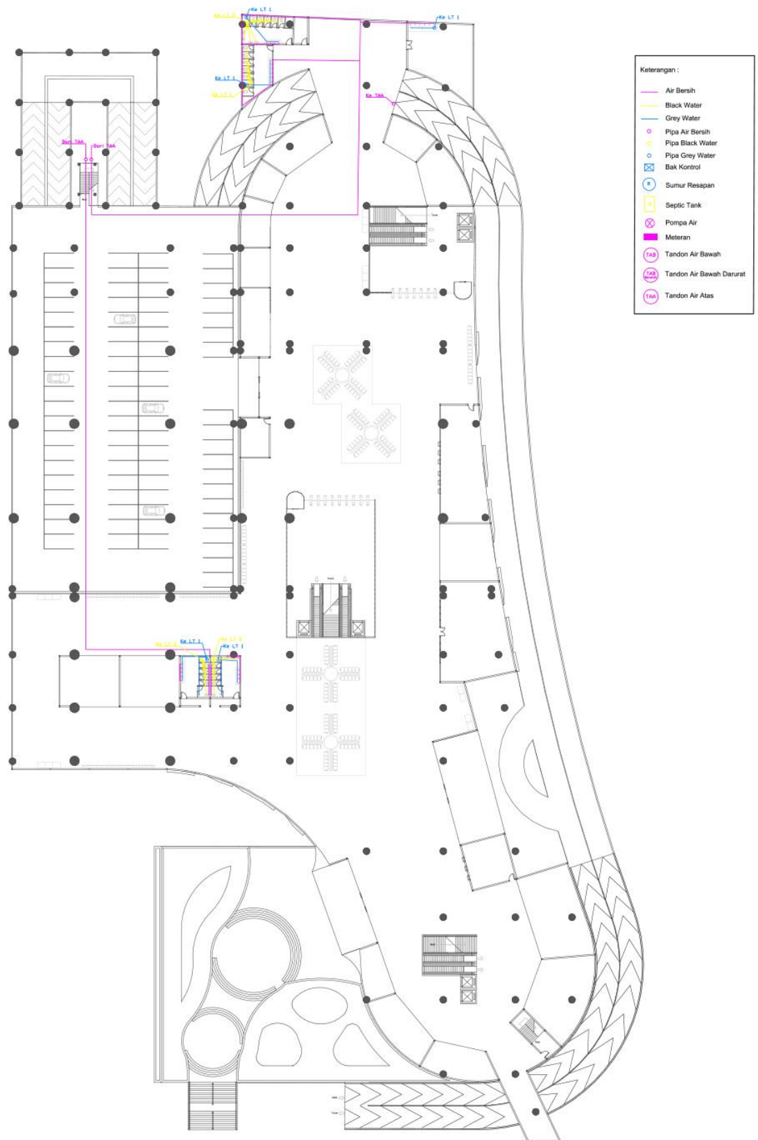
Gambar 5.24 Utilitas Plumbing Lantai 2 (Dokumentasi Penulis, 2020)
