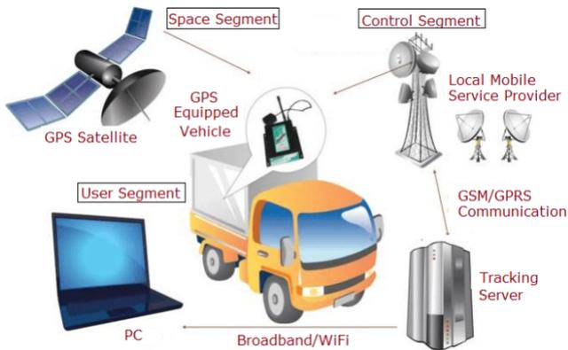
**Gambar 2.4:** Ilustrasi segmen GPS pada mobil angkut.[4]
